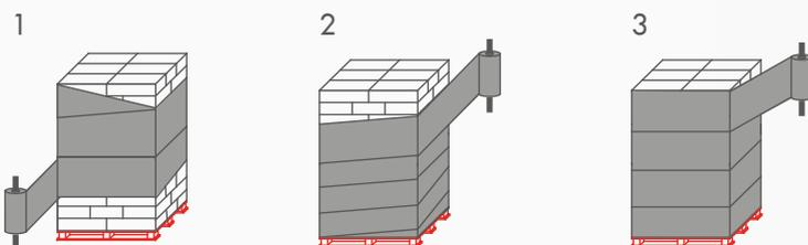
4. Envoltura tipo banda a cualquier altura
