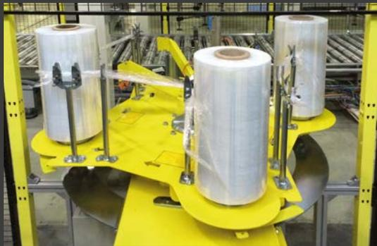
ARC: Cambio de bobina automático
