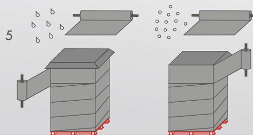
6. Envoltura individual de pallets apilados [con dos soldaduras] o como si fueran un solo palet
